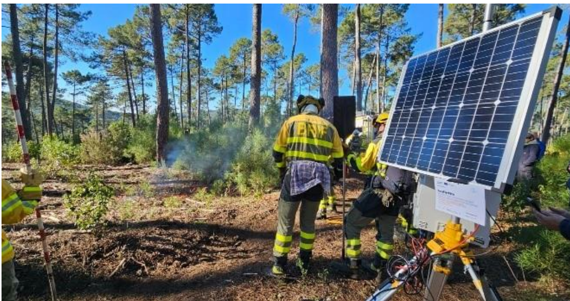
Módulos con sensores instalados en la zona piloto durante una quema prescrita. / IMB-CNM
